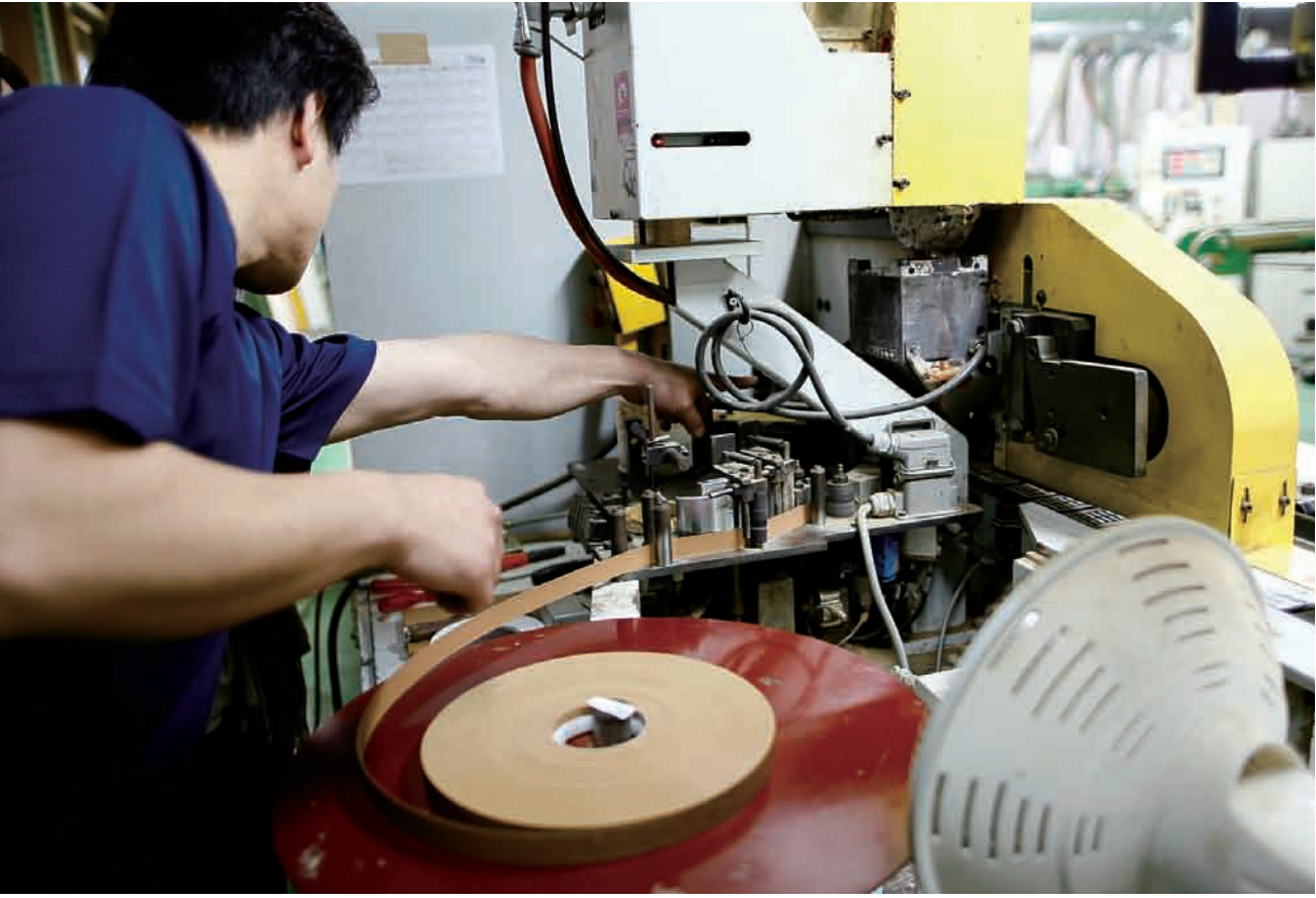
板材側面の加工 精度とスピードは機械の良さを活かしながら、細部は手仕事で仕上げます。
