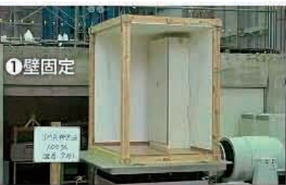
家具の耐震実験 震度7の地震 (関西淡路大震災の揺れ)を再現
