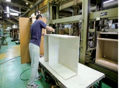
パーツの組み立て 組み立てる順番にでき上がってくるパーツを、表面に傷がつかないように組み上げます。
