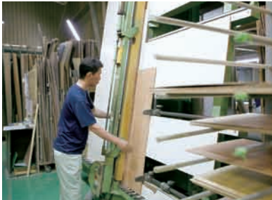
ボードの製作 板材の切断は、効率の良さとムダを出さない歩留まりの良い木取りを考えながら作業を行います。
