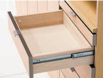
ダブルエクステンション・オートクロージング 標 重さ10kgの物を載せても軽くスライド(日本製)。二段階で奥まで引き出せます。閉まり際で引出しが自動で引き込まれます。
