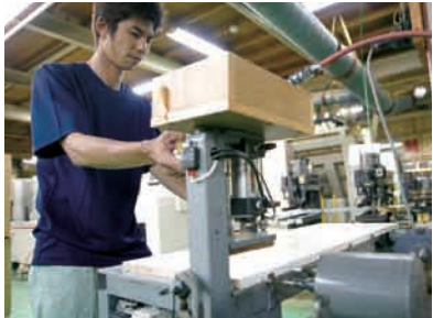
細部の加工 機械による精度の高い加工を行いながら、つねに人の目と手で仕上がりをチェックし、高品質を保持します。
